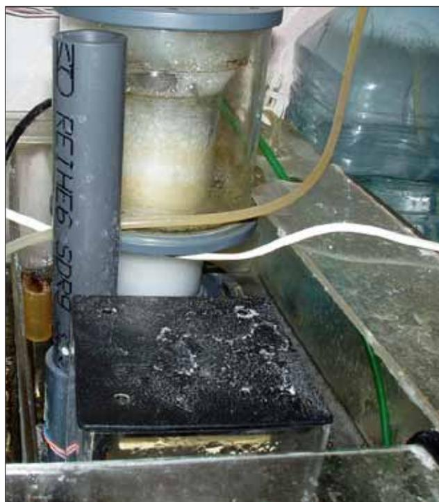
Третья часть внешнего фильтра предназначена для размещения возвратной помпы, в ней же расположен активированный уголь. Небольшое количество активированного угля
